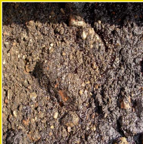
Iskopano tlo onečišćeno katranom (nepopisani otpad)
