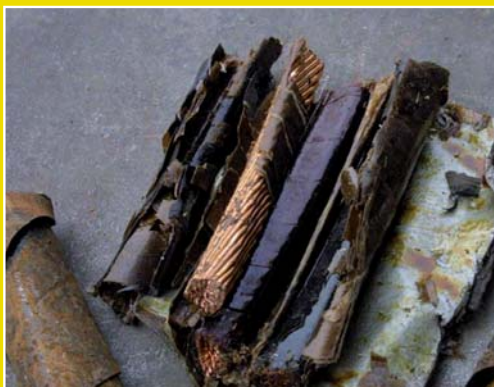
Otpadni kablovi s opasnim spojevima (A1190) (Hessische Abfalltransportdatenbank)
