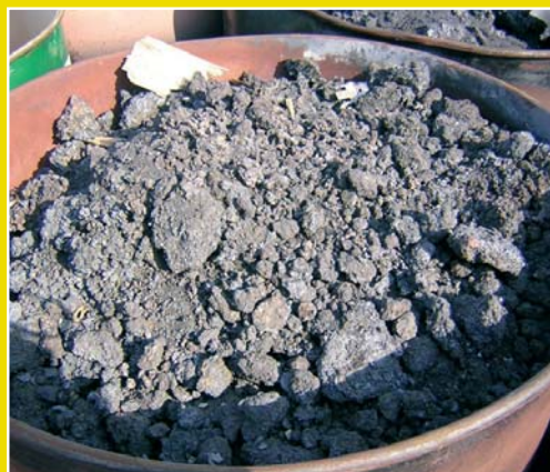
Materijal za rafiniranje bakra koji sadrži više od 0,5 % spojeva olova (teratogeno) (A1020)
