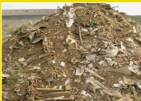
Miješani otpad od rušenja objekata (nepopisani otpad)
