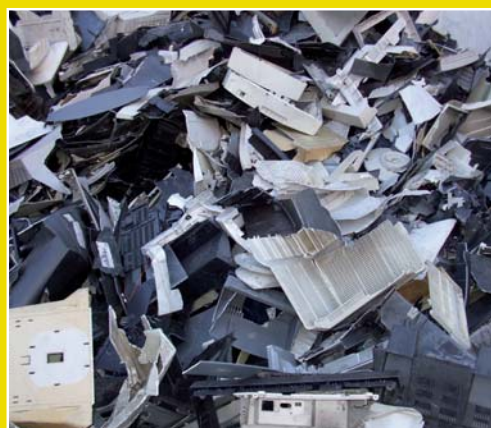
Plastični otpad od kućišta za monitore; analiza pokazala visok sadržaj zabranjenog PBDE-a (nepopisani otpad)
