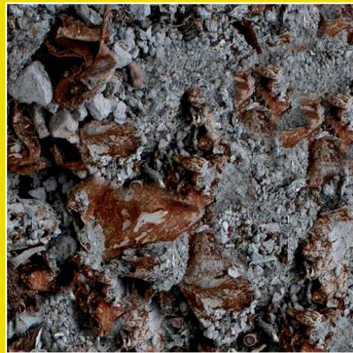
Željezni otpaci s velikom količinom troske iz spalionice komunalnog otpada (nepopisani otpad) (BMLFUW)
