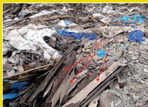
Miješani otpad od rušenja objekata, sadrži azbest (nepopisani otpad) (A2050) (Hessische Abfalltrans- portdatenbank)
