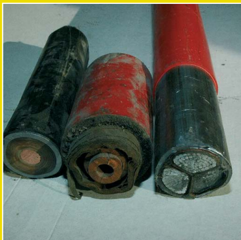
Podzemni kablovi, sadrže ulje
