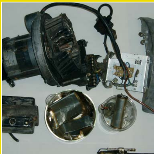
Električni motor s kondenzatorom koji sadži PCB-e (A1180)
